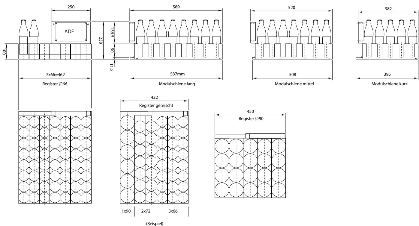
Die Kontrollregister können in drei Längen mit Modulschienen in drei Breiten (= Flaschen-Ø) individuell zusammengestellt werden. Massgebend für die Grösse ist der Innenraum der Kühlschubladen. Pro Auslese-Elektronik ADF können max. 8 Produkte zu je 8 Einheiten verwaltet werden.
